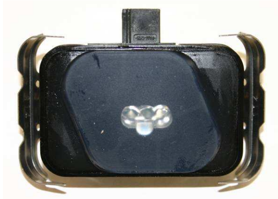
Regensensor mit integriertem Lichtsensor
