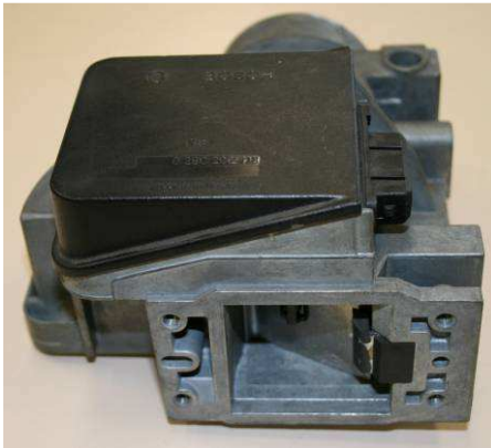
Luftmengenmesser einer Bosch L-Jetronic
