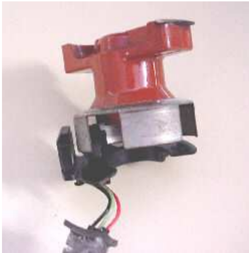
Hallgeber in einem Zündverteiler
