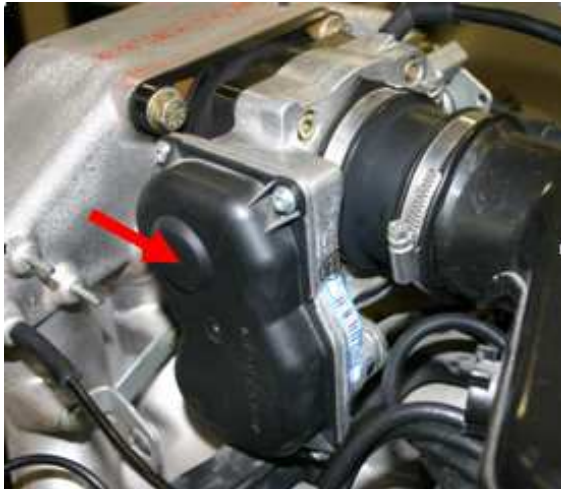
Drosselklappensteller mit doppeltem Potentiometer
