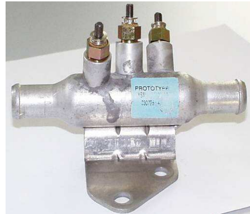
Elektrischer Zuheizer im Kühlkreislauf
