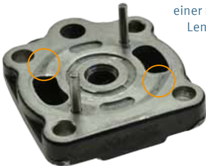
Gehäusedeckel der Lenkhilfpumpe: Riefenbildung an der Auflagefläche des Flügelrads durch verunreinigtes Hydrauliköl
