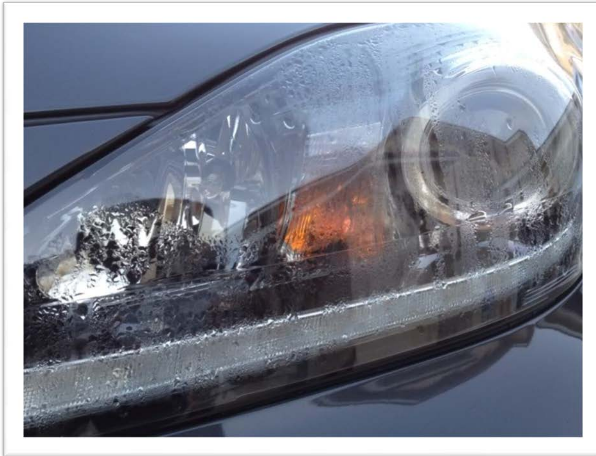
Scheinwerfer mit Dichtigkeitsproblem
