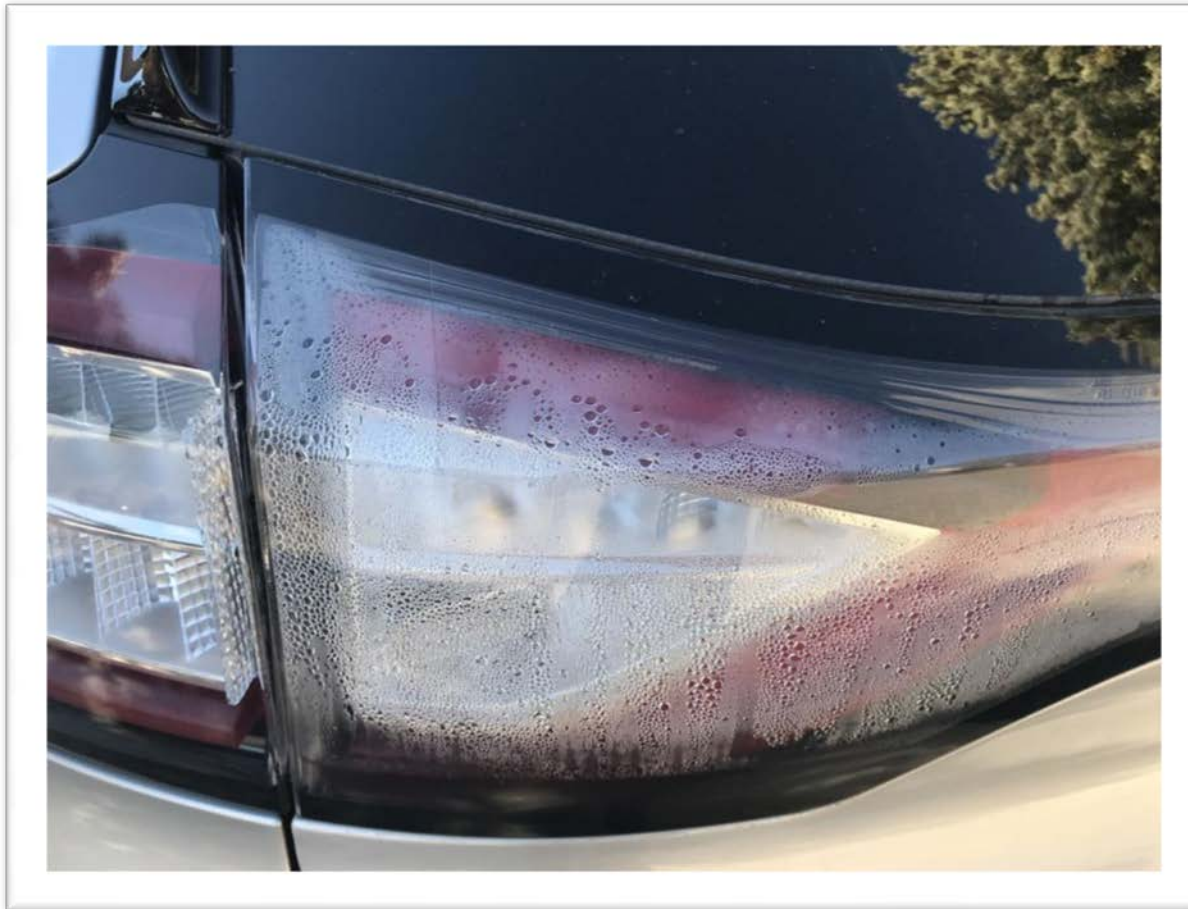
Rückleuchte mit Dichtigkeitsproblem
